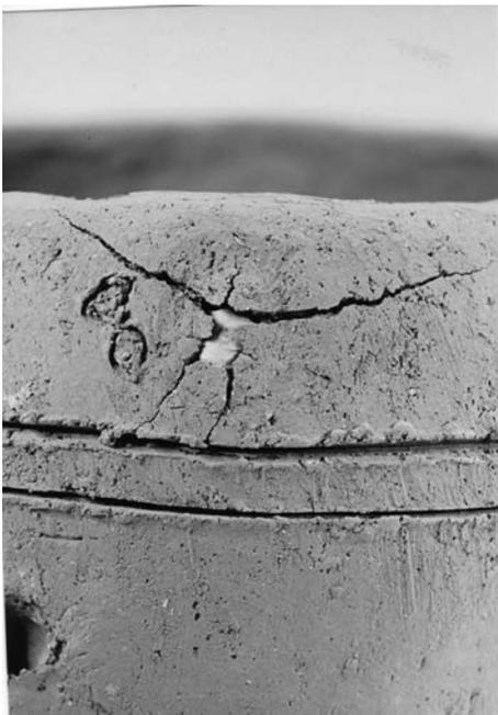
図 26 マメの膨張によってひび割れの生じた例
