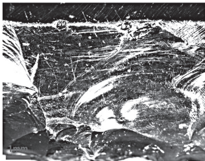
図 2-10 写真 3：線状痕 (平行)、稜線つぶれ
