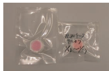
「パッシブインジケータ」による測定結果(アンモニア)。変色が少なく結果は良好
