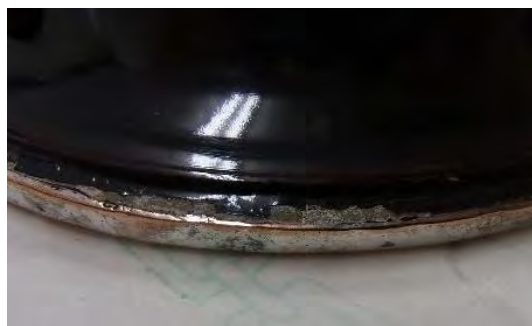
図 12 覆輪接合部分の破損部
