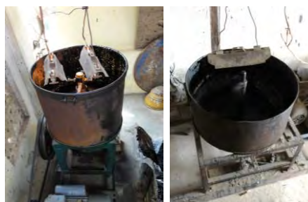
図3 漆液の精製機（バガン：2010年）
