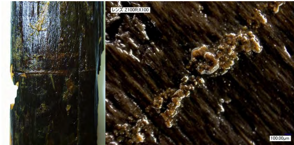
写真3 加工木 No.113 掻き傷部 (左) とマイクロスコープ写真 (右) (右写真は宮腰哲雄氏提供)
