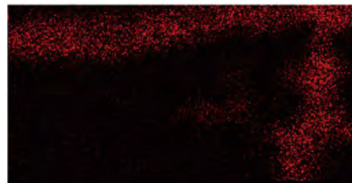
図 14 EDX によるマッピングの結果 (Hg)
