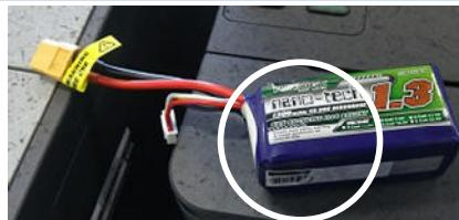
**写真上** 発火したリチウムポリマーバッテリー
