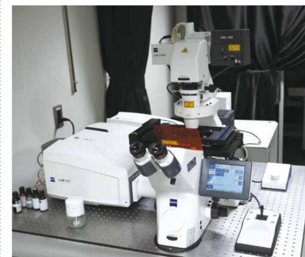
図1:生命科学科の共通機器、高速の超解像と高感度の共焦点画像取得が可能な最新の共焦点レーザー顕微鏡(Zeiss LSM880 with Airyscan Fast)
