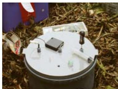
図4:炭酸ガス採取チャンバー
