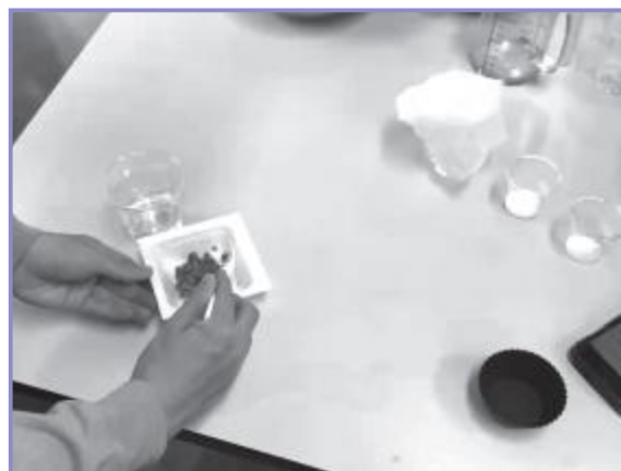
納豆から生分解性プラスチックを作る実験
