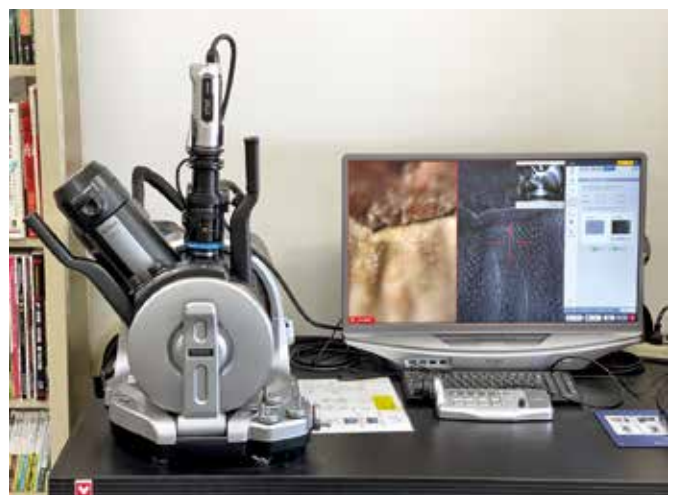
写真1 (株) キーエンスの超深度マルチアングルレンズとコントローラー
