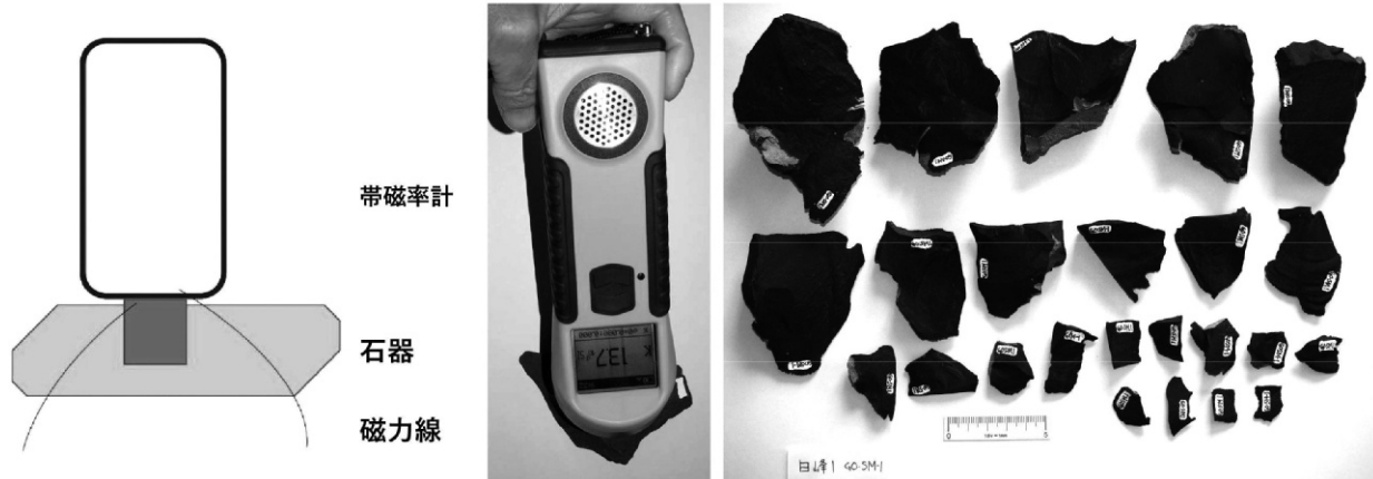
図2 帯磁率計の原理
