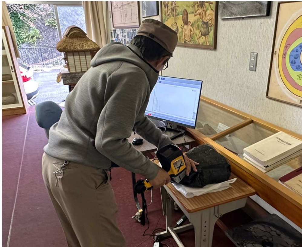
P-XRFによる見高段間遺跡原石の測定状況
