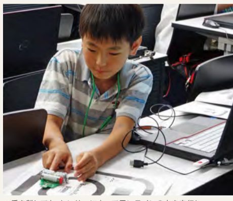
▲手を離しても、センサーによって黒いラインの上を走行!
