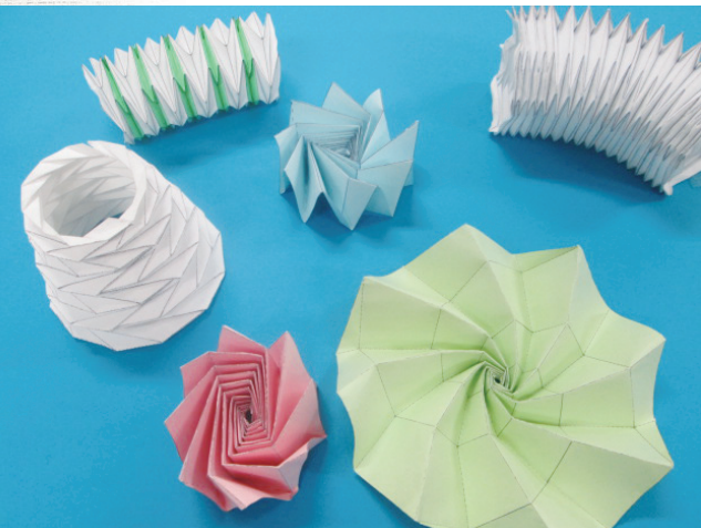
折りたたみ可能な形状の紙による試作。折りたたむための条件式を解いて形状を決めます。
