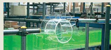
維持管理が容易で、環境に配慮した水路や取入堰などの水利施設の開発や改良をするために模型を製作して実験を行っています。写真は、農業用水路を使った小水力発電のための水車の実験をしているところです。
