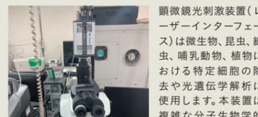
顕微鏡光刺激装置(レーザーインターフェース)は微生物、昆虫、線虫、哺乳動物、植物における特定細胞の除去や光遺伝学解析に使用します。本装置は複雑な分子生物学的操作を必要とせず、あらゆる生物種に容易に適用でき、拡張性も非常に高い装置です。
