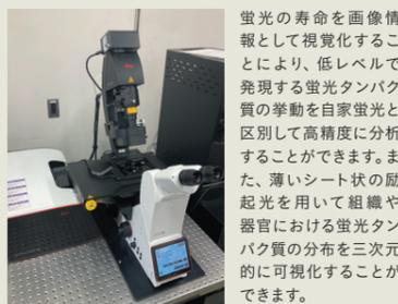
蛍光の寿命を画像情報として視覚化することにより、低レベルで発現する蛍光タンパク質の挙動を自家蛍光と区別して高精度に分析することができます。また、薄いシート状の励起光を用いて組織や器官における蛍光タンパク質の分布を三次元的に可視化することができます。
