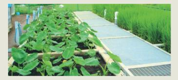
作物を実際に栽培しながら、降雨量、灌水量、および排水量を観測し、作物の蒸発散量(要水量)を経時的にとらえるための施設です。地下水を調節することも可能であり、作物生産において重要な水収支との関係を定量的に解析しています。
