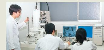
物質の表面構造を観察するとき用いられる電子顕微鏡。微生物の丸ごとの形態や動植物の組織構造などの観察に利用されています。
