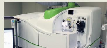
高温のプラズマと磁場の中に液化試料を導入し、わずかな質量差を捉えて土壌、動植物など、物質を構成している多元素の微量分析ができます。
