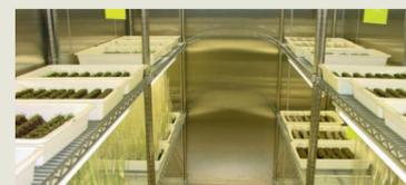
光や温度を人工的に調節できる培養室です。遺伝子導入した細胞からの植物個体の再生や、低温・乾燥などの環境条件に対する植物の応答や遺伝子機能の解析に利用しています。
