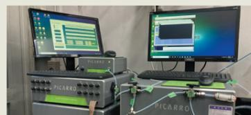
亜酸化窒素(N<sub>2</sub>O)、メタン(CH<sub>4</sub>)、二酸化炭素(CO<sub>2</sub>)ガス濃度とそれぞれのガスに含まれる微量な窒素・炭素安定同位体比を連続的に測定できます。時々刻々と変化する環境因子(地温、土壌水分量など)に呼応して変化する微生物活性によって温室効果ガス放出・吸収が変化するため、連続的なデータを得ることでこれまで見逃してきた多くの新たな現象が捉えられます。
