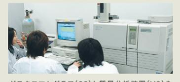
ガスクロマトグラフ(GC)と質量分析装置(MS)を結合した複合装置です。GCで分離した単一成分についてMSスペクトルを測定することにより成分の定性を行い、MSにより検出されたイオンの強度により定量を行います。有機化合物(特に低分子量成分)の定性・定量を目的とした分析に活用しています。
