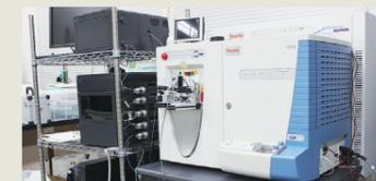
複合試料が高速で分離できる装置に最先端の質量分析計を結合させた機器。ペプチドなど低分子化合物の質量を素早く高精度で分析できます。
