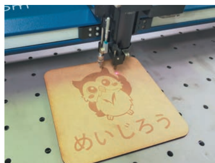
レーザー加工機で材料(左：木質ボード、右：真鍮)の表面に彫刻した例
