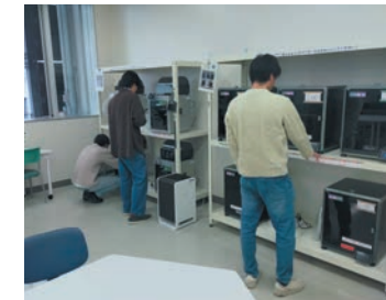
3Dプリンターは幅広い素材で造形可能(写真左) 真空成形機は薄いプラスチック成形が可能(写真右)
