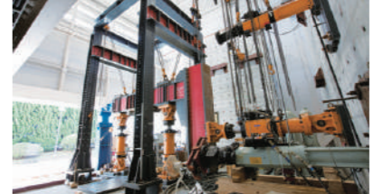
構造物試験棟 地震に対する構造物の耐震性能を研究する主要施設
