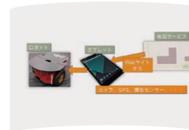
タブレットのセンサを使ってロボットの動きを測定
