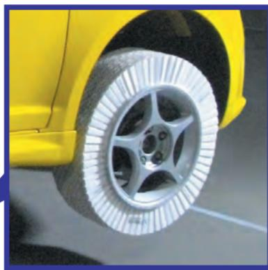
折紙で作ったタイヤを取り付けた走行実験車。柔らかい素材(紙)でも形を工夫すれば重たいものを支えることができる。折紙は形の工夫の可能性を広げる
