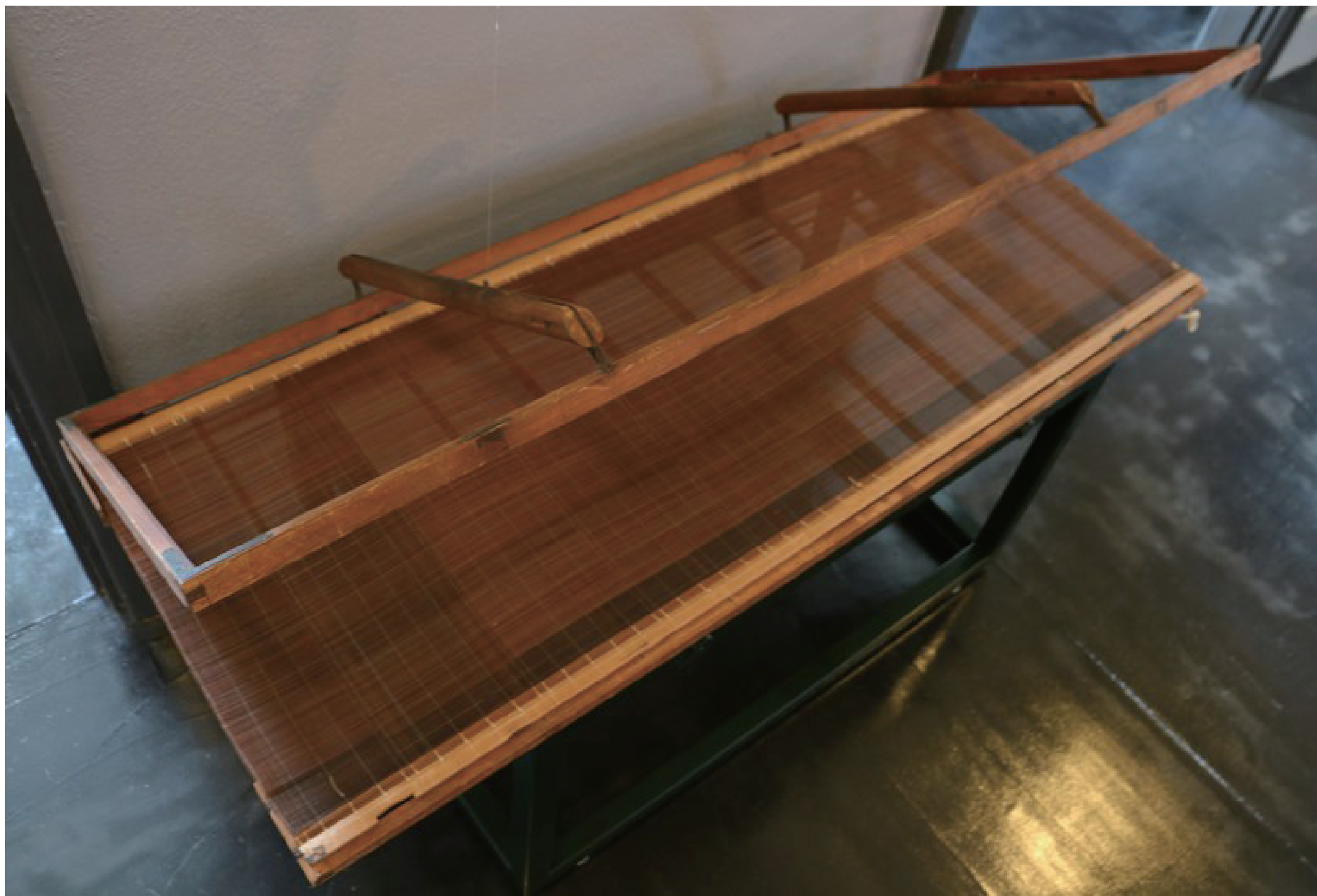
↑ すげた 気球用和紙抄紙用簀桁（紙漉き機） ※第二展示室に展示中 山梨県・市川大門で実際に使用されていた簀桁。サイズ 147.1cm × 577cm。 明治以降、改良漉きが各地に広まり、従来より大型の簀桁が導入され、一度に 数枚分の和紙を漉くようになった。この簀桁で小型の「五号」用紙を1度に2 枚分漉き、規格通りに断裁して出荷したと推定される。 各気球用紙の規格に併せて、簀桁が特注され（主に高知県産）各生産地に納め られた。
