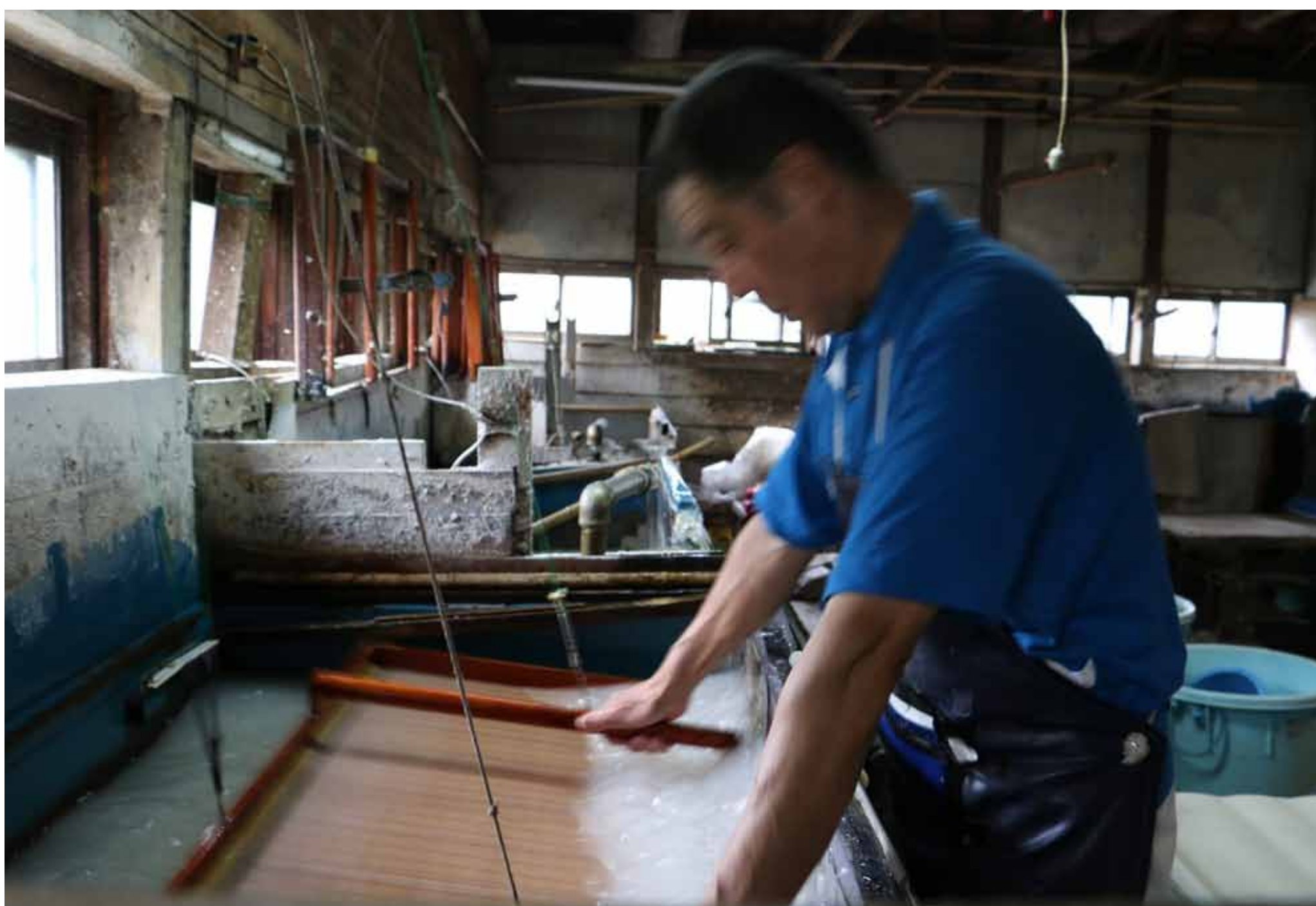
3. すくいあげた紙料を簀桁で縦横にゆすり紙を漉く
