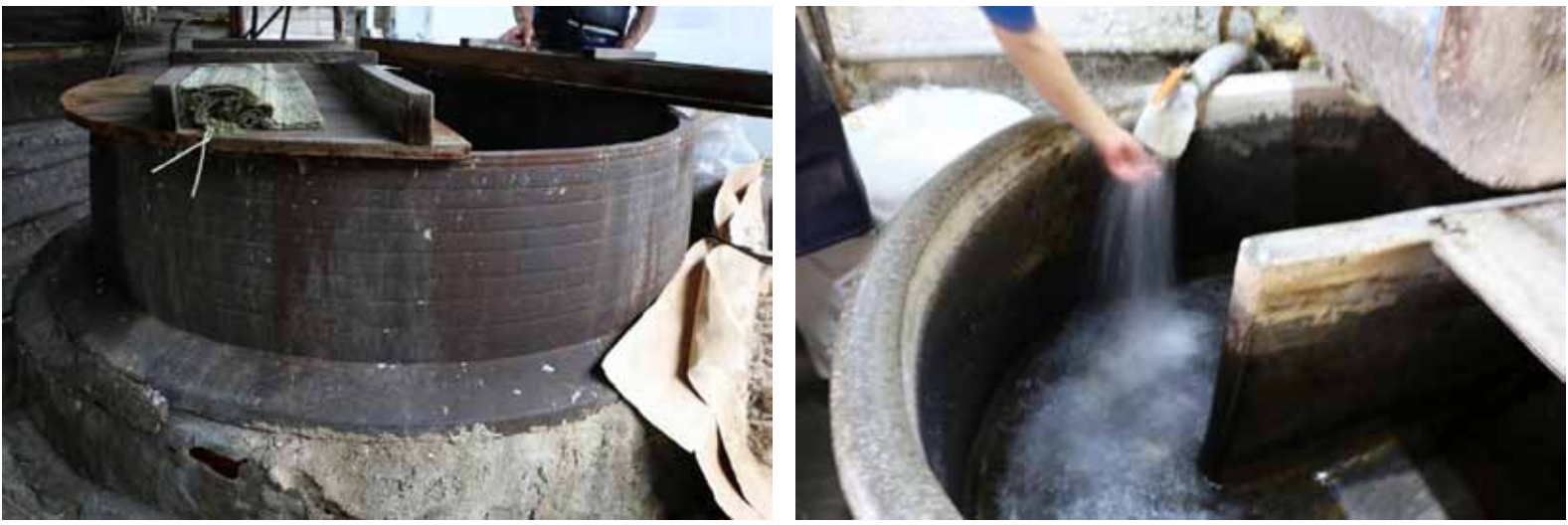
蒸煮釜（左）とビーター（藤原製紙所にて資料館撮影） 和紙製紙所に現存する昔ながらの大きな蒸煮釜。紙の原料を煮る。ビーターでは装置内で原料を循環させながらすりつぶし，紙のもととなる紙料をつくる。
