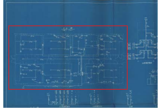
「昭和三十一年七月 第二種自家用電気工作物図面 第六号図の六 電灯配線図（部分）」
