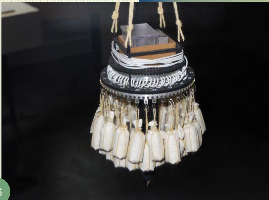
高度が低下するとパラストを自動的に投下して浮力を回復する。
