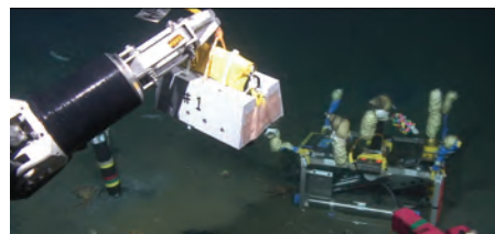
図4) 無人探査機(ROV)によるモニタリング装置の回収と設置
