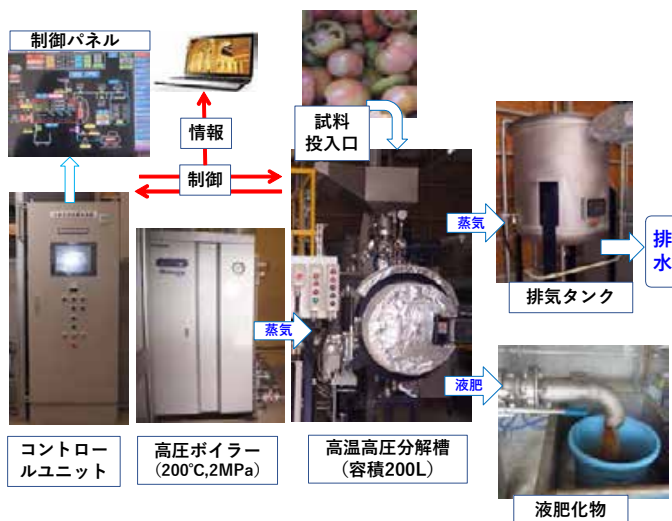
図 1-5 水熱分解装置の構成
