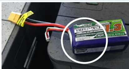
写真上 発火したリチウムポリマーバッテリー 左下部が膨らんでいます。 こうなったら非常に危険なサイン。 安全に注意して直ちに廃棄しましょう。
