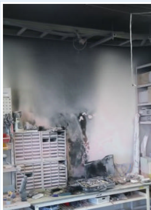
写真上 発火したリチウムポリマーバッテリー 左下部が膨らんでいます。 こうなったら非常に危険なサイン。 安全に注意して直ちに廃棄しましょう。
