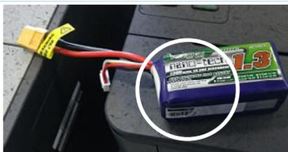
**写真上** 発火したリチウムポリマーバッテリー
