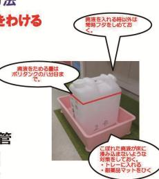
実験室内での廃液の貯留方法(例)
