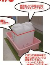
実験室内での廃液の貯留方法(例)
