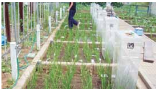
写真1：農学部南圃場ライシメーター施設で水管理の違いがGHGs排出量へ与える影響をチャンバー法で測定中
