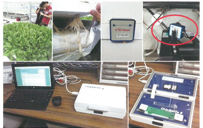
図1：黒川農場でのホウレンソウ水耕液のサンプリング風景（上段左）（岡部勝美特任教授との共同研究）C4D検出器の写真（上段右）マイクロチップ用C4D装置とその内部（下段）
