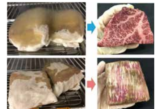
図2 エイジングシートを用いた熟成試験
