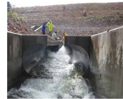
ため池の放流施設の機能を調査するための現地実験
