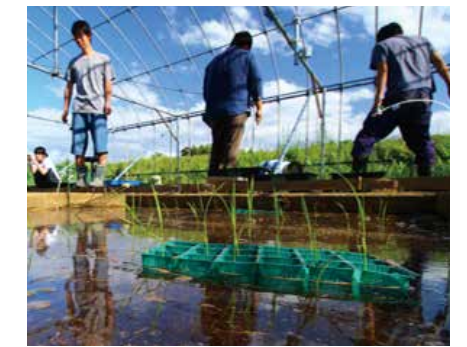
南圃場にあるライシメーターを使ったイネの栽培実験
