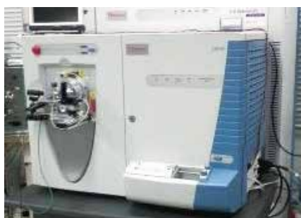
液体クロマトグラフ質量分析計(LC-MS/MS);生体分子の質量を高感度で分析します
