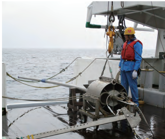
海鷹丸調査でのピストンコアラによる試料採取
