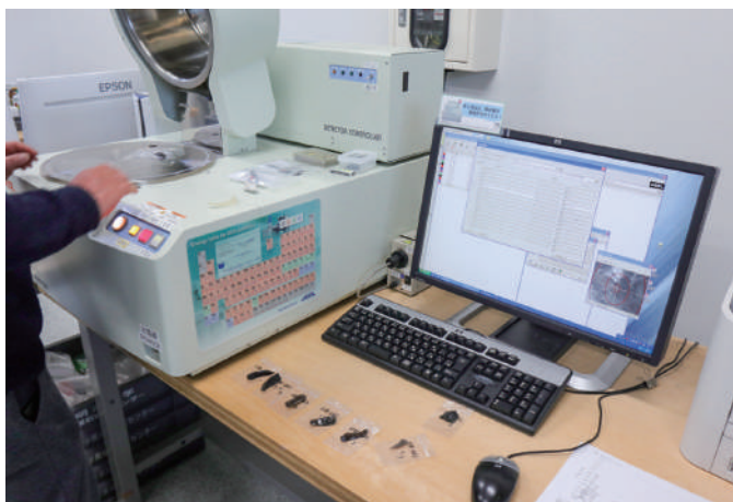
蛍光X線分析装置による黒耀石の測定
