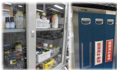
保管場所は必ず施錠 毒劇庫には法定表示
