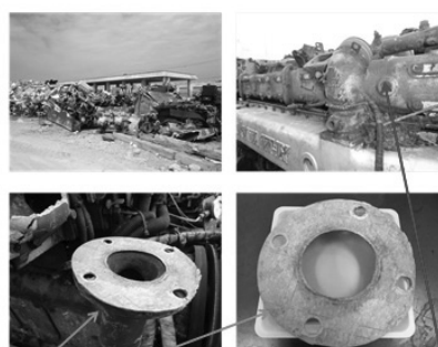
アスベスト(クリソタイル)を含有する布状の断熱材
