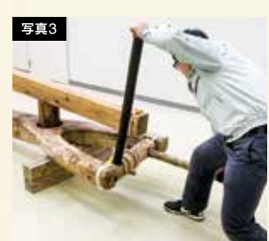
万力方式の搾油機。圧力がかかることで椿油が抽出される。
