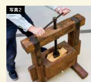
万力方式の搾油機。圧力がかかることで椿油が抽出される。
